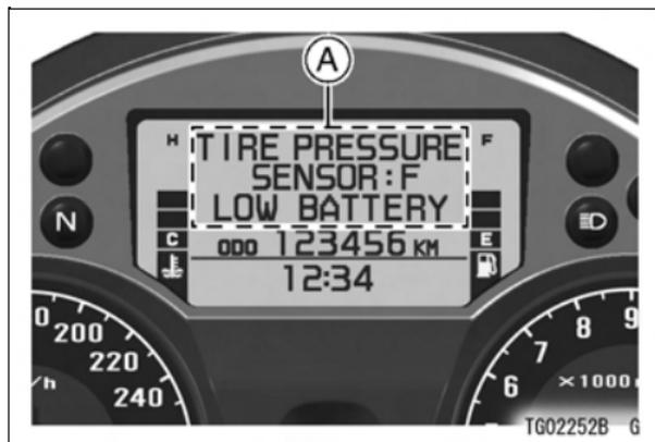
A. Warnmeldung Reifenluftdrucksensorbatterie (Vorderseite)
